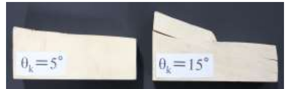
図4 载荷後の楔の変形
