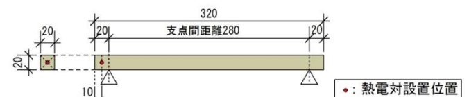
図5 試験体図及び熱電対設置位置
